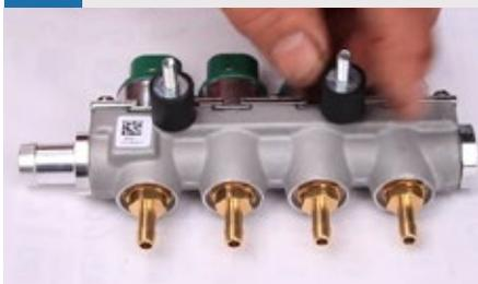
**3** Montaggio sensore di pressione
