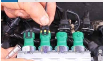
**6** Rail montato correttamente
